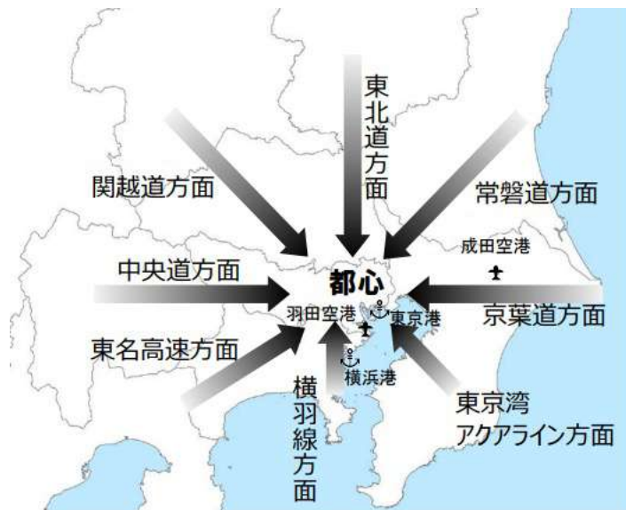
図3 首都直下地震に備えた“八方向作戦”による道路啓開
